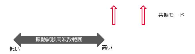
振動試験の周波数範囲の共振モードが存在しない場合、 試験範囲で適度に周波数スイープさせた調和解析を実施
