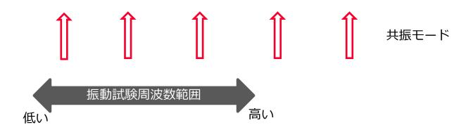
振動試験の周波数範囲の共振モードにフォーカスした調和解析を実施する 上図の場合は3つの共振モードにフォーカス
