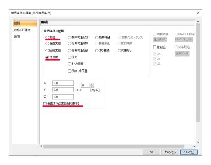
振動試験機に取り付ける 部位(面)に対して 振動振幅の場合は変位 振動加速度の場合は加速度 の境界条件を設定する
