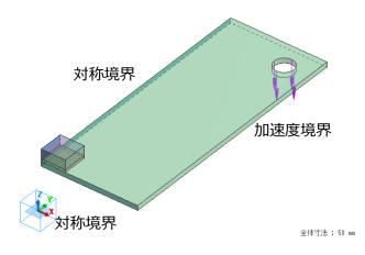
基板の中央に部品が実装された状態をイ メージした1/4対称モデルです。
