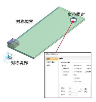
基板の中央に部品が実装された状態をイメージした1/4対称モデルです。
