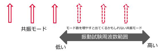
共振解析結果の共振モードの周波数が試験範囲よりも低い場合、 さらにモード数を増やすと試験範囲の共振モードが得られる可能性がある。
