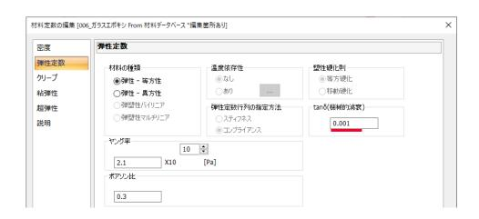
調和解析で共振ピークにおける変位や応力の絶対値を算出するには 材料の機械的減衰の設定が不可欠です。
