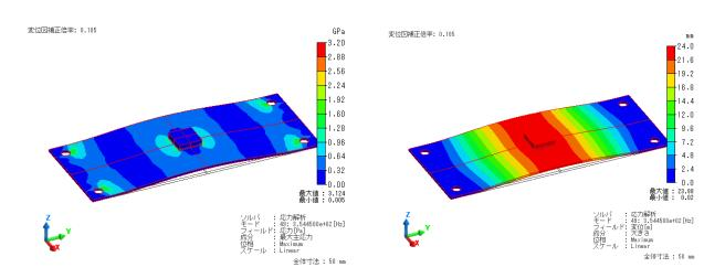
共振ピークにおける最大主応力と変位の大きさの最大値を表示しています。 各フィールドの値は位相設定によって変化しますので、最大値を求める場合は Maximumを選択します。
