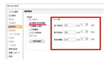
355Hz付近の共振モードのピークを含むような周波数スイープ設定としています。
