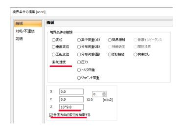
Z方向に10Gの振動加速が印加される場合を想定しています。
